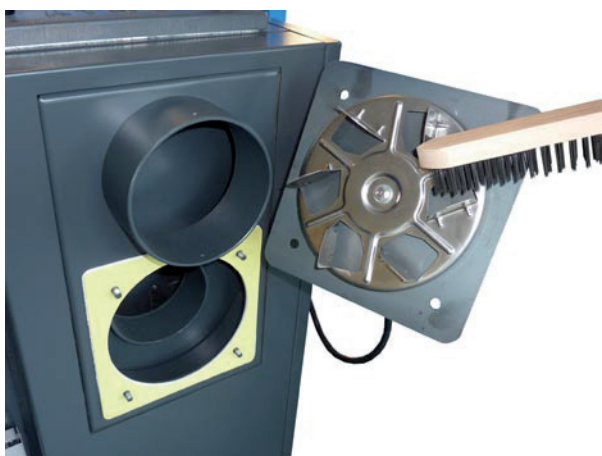
Esempio di pulizia della girante e verifica dell'integrità delle alette sul ventilatore di scarico
