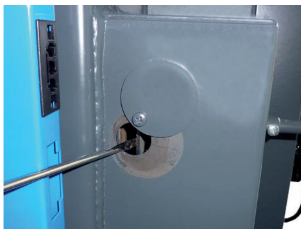
Controllo e pulizia della regolazione dell'aria primaria e dell'aria secondaria.
